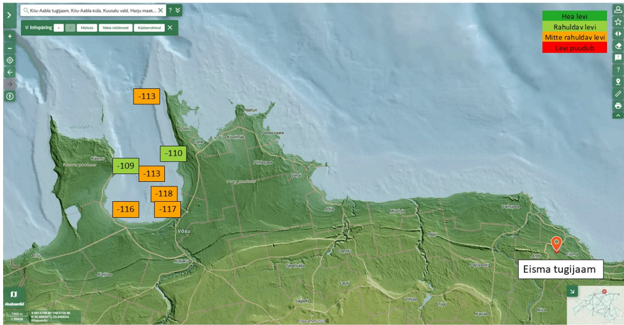
Joonis 3. Mõõtepunktid 1–7 käsiraadiojaama signaalivõimsuse mõõtetulemused Eisma kaldajaama suhtes. Väärtuste ühik dBm.
