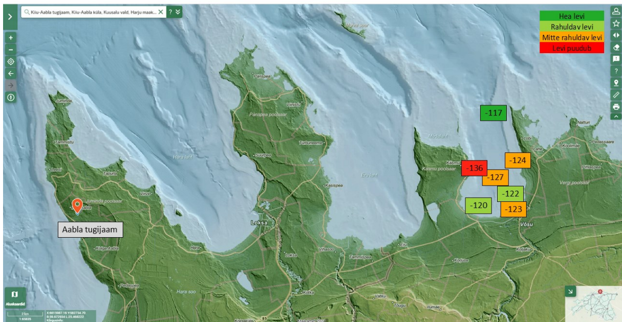
Joonis 2. Mõõtepunktide 1–7 käsiraadiojaama signaalivõimsuse mõõtetulemused Abla kaldajaama suhtes. Väärtuste ühik dBm.
